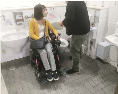
便座横のスペース確認 (車いすを横付けできるか)
